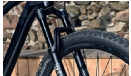
RESERVEN: Als einziges Bike im Test hat das Cirex 120 Millimeter Federweg an der Front.
